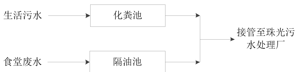
图 6.2-1 本项目污水预处理流程图
